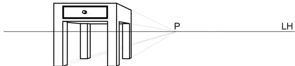
Dibuja una mesa desde los distintos puntos de vistas a partir de los datos dados. Ten en cuenta las tres dimensiones: ANCHURA: paralelas a las LH, ALTURAS: perpendiculares a LH y PROFUNDIDAD: convergentes al punto de fuga P.
